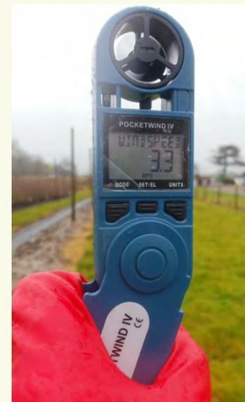
Messgerät zur Erfassung der Windgeschwindigkeit
